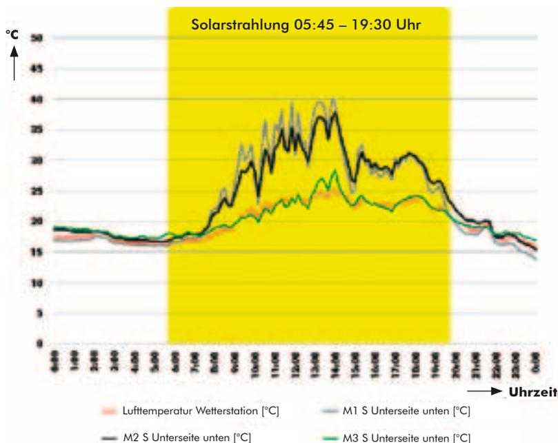
Messdiagramm: Beispielhafte Temperaturkurven an einem Tag im Juli. Die Temperatur der Module über den Bitumenbahnen (schwarze und graue Kurve) steigen bis fast 40 °C an, während das Modul über der Dachbegrünung (grüne Linie) bei max. 27 °C bleibt und damit ganz nah an der Umgebungstemperatur (rote Linie).
